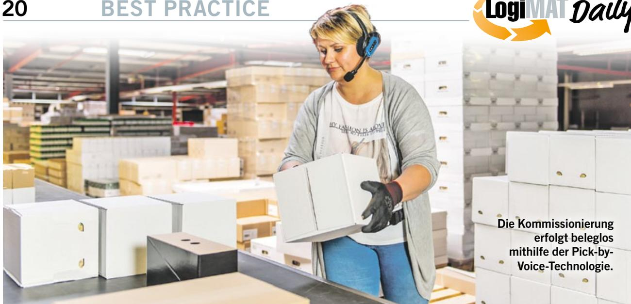
Die Kommissionierung erfolgt beleglos mithilfe der Pick-by-Voice-Technologie.
