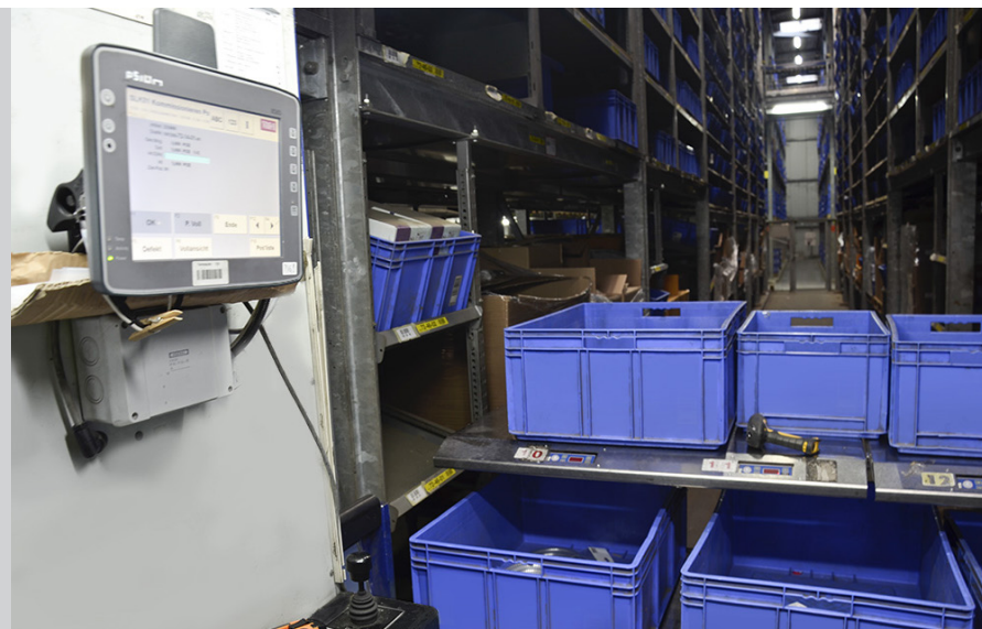
Put-to-light signalisiert auf den Fachanzeigen des Kommissionierwagens den korrekten Zielbehälter.
