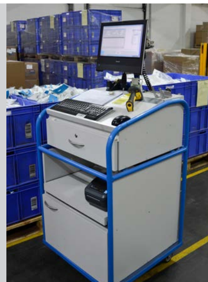
Mobile Warenannahmepplätze und mobile Handgeräte funktionieren über WLAN.
