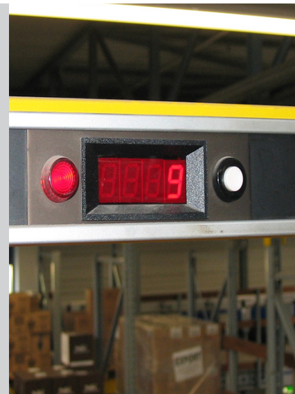
Pick-by-Light unterstützt die Kommissionierung
