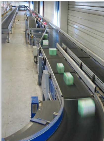
Umlaufendes Förderband sorgt für sicheren Transport
