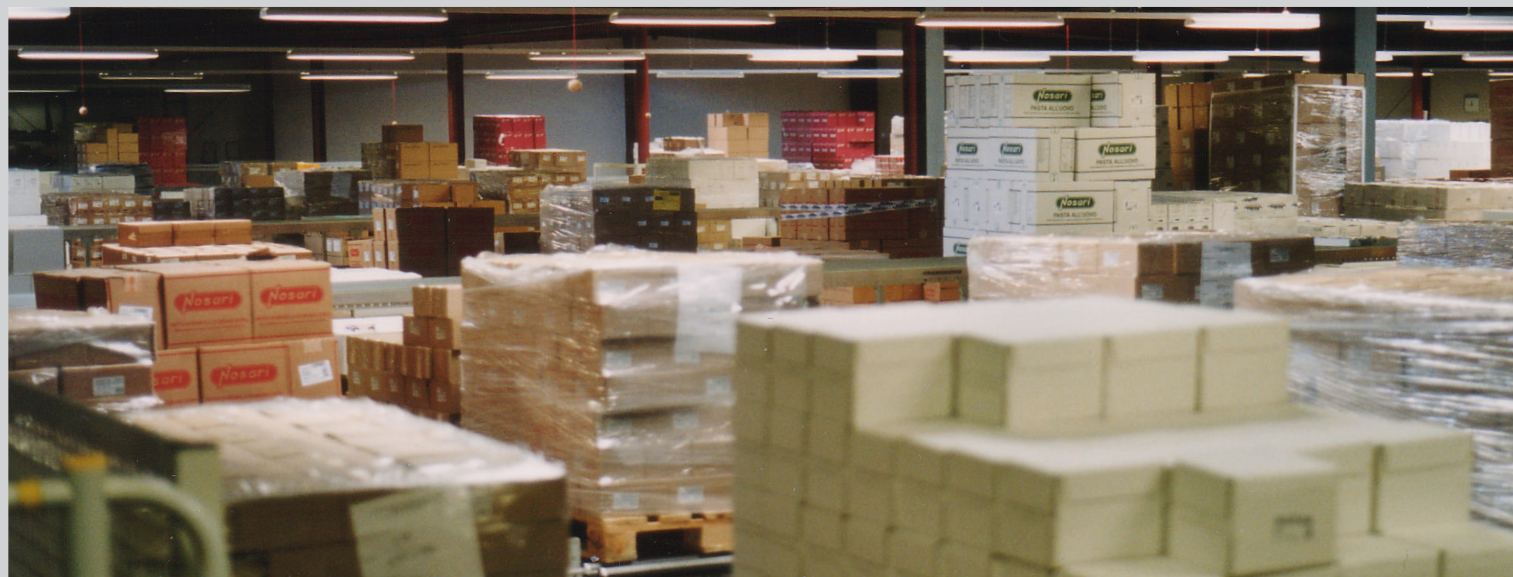
Kommissionierlager mit 1.000 Palettenstellplätzen und 500 Stückgutregalplätzen
