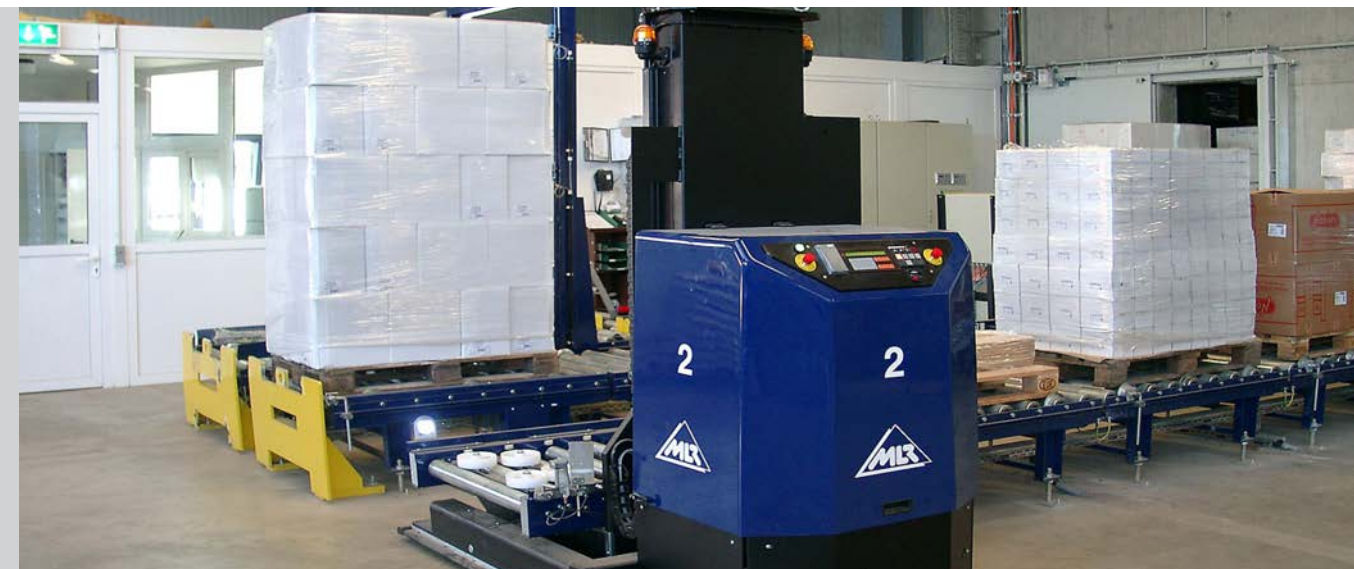
Vollautomatischer Wareneingang mit FTS
