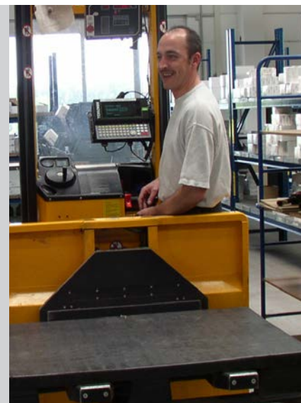
Funkgestütztes Staplerleitsystem mit integrierter Staplerwaage
